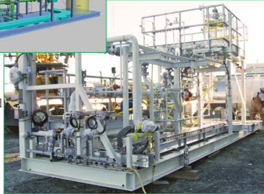
Les outils de conception numérique nous aident à visualiser, à planifier et à réaliser une fabrication personnalisée complexe. Cette plateforme de chargement au propane a été conçue, fabriquée et installée pour ExxonMobil.
